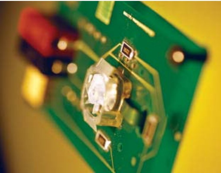
Unter Einsatz von Mikrostrukturierungstechniken hergestellter Mikrolüfter zur Kühlung von Leistungselektronik und Sensoren. Quelle: Fraunhofer-Institut für Zuverlässigkeit und Mikrointegration
