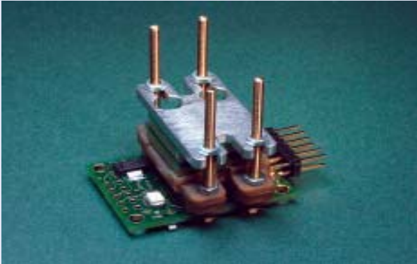
Versorgungsleiterplatte mit Adapter für den Test von Modulstacks oder für den Test von einzelnen Modulen. Quelle: Fraunhofer-Institut für Zuverlässigkeit und Mikrointegration
