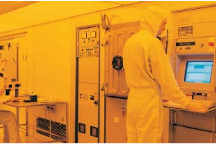
Nicht nur in Reinräumen werden hoch qualifizierte Fachkräfte für die Mikrosystemtechnik gebraucht. Das Foto zeigt Anlagen zur Oberflächenmodifikation von Mikrostrukturen. Quelle: STEAG microParts GmbH
