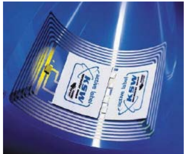
Aktives Smart Label mit Temperatursensor und Polymerbatterie. Quelle: KSW Microtec AG
