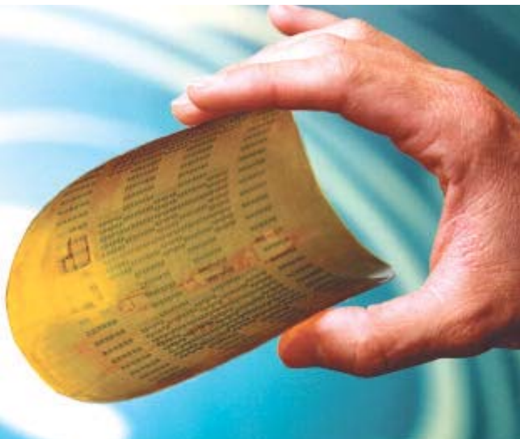
Flexible 6-Zoll Polyimid-Folie mit verschiedenen elektronischen Komponenten und Test-Schaltkreisen. Die Schaltkreise funktionieren auch, wenn die Folie stark gebogen wird. Quelle: Philips Research
